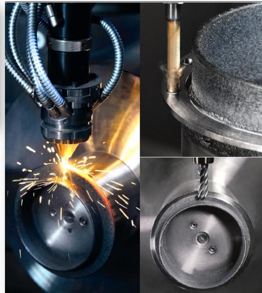
增材加工 (直接激光烧结)
