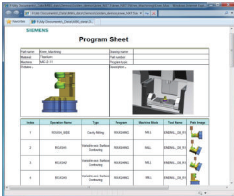
图 6：集成机床仿真实现对 CAM 系统里面的 CNC 程序的验证
