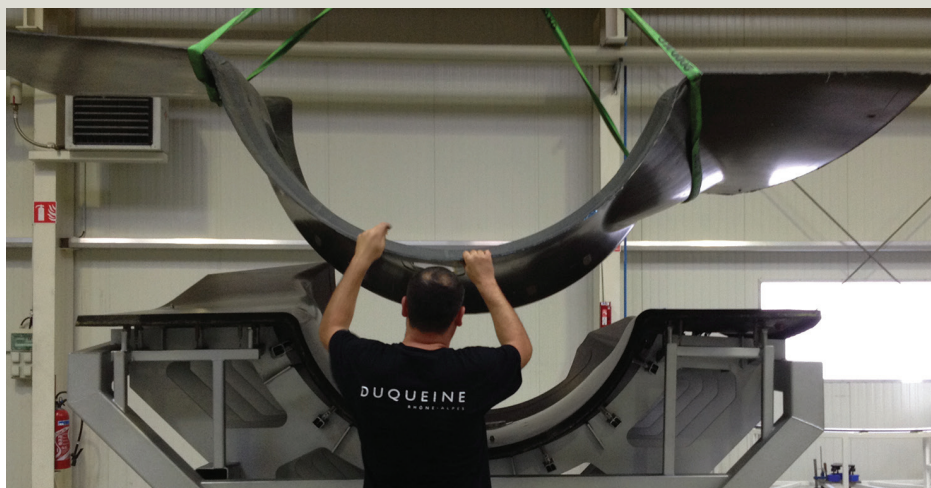
发动机测试设备IFS夹层部分的脱模过程。
