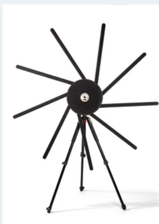
无论是在室内还是现场、用于小型手持工具还是巨型工程机械、接近声源还是远离声源，LMS 声学照相机数字阵列都能调整至满足各种测试工况要求的状态，并在各种测试情况下即时准确地定位声源。
