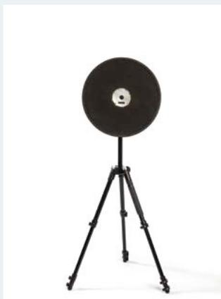
LMS 声学照相机数字阵列是一款可用于声源定位的模块化高品质数字麦克风阵列。可用于声源定位。这是一款易于设置和使用的工具，可帮助一般用户和专业工程师快速、准确地洞察声学故障。该设备具备多功能解决方案的系统，配备可拆装悬臂，是一款能够在多种测试条件下使用的理想工具。
