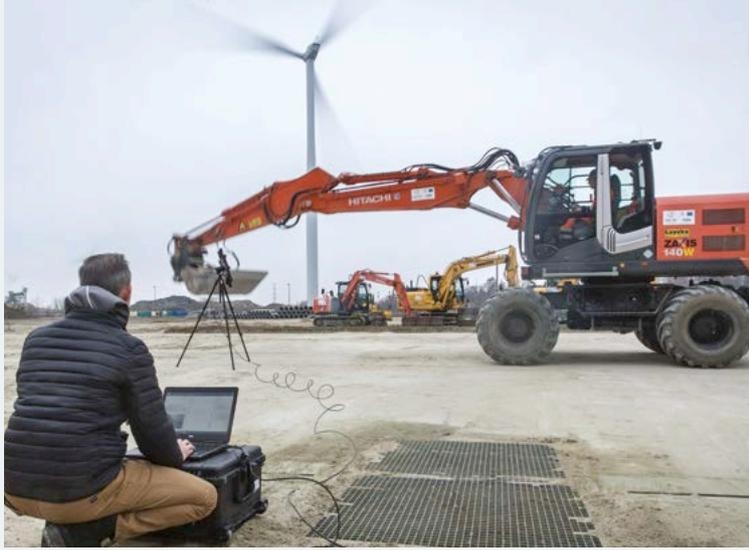
虽然运动的噪声源更难捕捉，但LMS声学照相机仍可以对其进行声源定位：如运动的雨刷、关门和起重机工作的移动臂等运动的噪声源，以及如传动系统启动、齿轮运转和制动系统等操作动作不断变化的噪声等。
