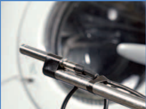
洗衣机的测试需要很长的时间。LMS Test.Lab支持在任何时间间隔下在线计算声功率级。
