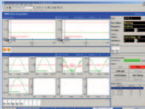
在数采前端中幅值和相位控制相结合，以得到最佳控制循环时间。
