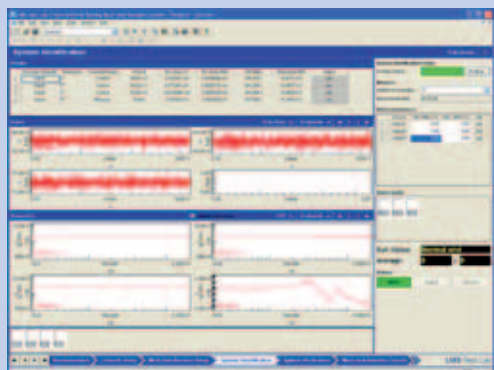
MIMO自检系统安全特点：驱动限制和对单个通道的均方根值安全检查。
