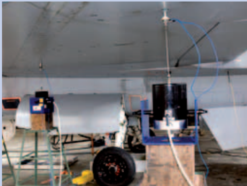
幅值扫描可对结构的非线性进行更贴切的研究。
