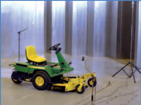
许多户外设备制造商必需遵守EC/2000/14标准，LMS为量化测试和研发分析提供解决方案。
