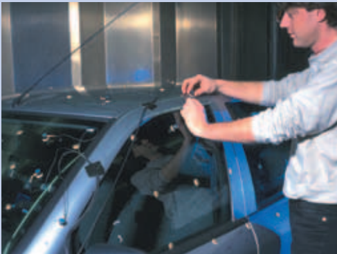
多通道的多激振器MIMO试验提供了一个非常高效的模态试验解决方案。
