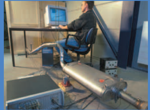
FRF测量与模态分析试验的方法相同。
