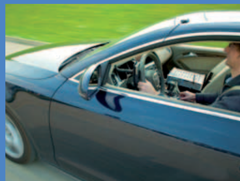
应用LMS SCADAS采集系统的In-Vehicle室外通过噪声设置。
