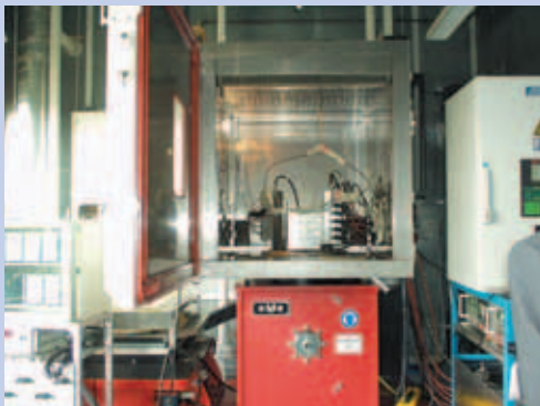
通过对温控箱的远程控制，试验序列控制能够将振动试验和高低温试验组合在一起。
