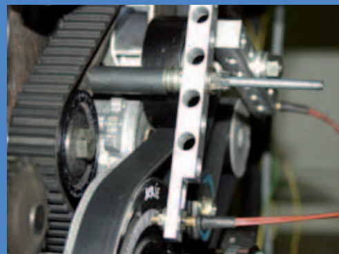
来自轴编码器或齿轮的脉冲信号被转换为瞬态转速波动，并与其它振动通道一起进行信号分析。
