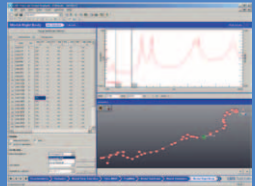
LMS Test.Lab刚体特性计算模块提供了包含几何动画的有效数据选择。
