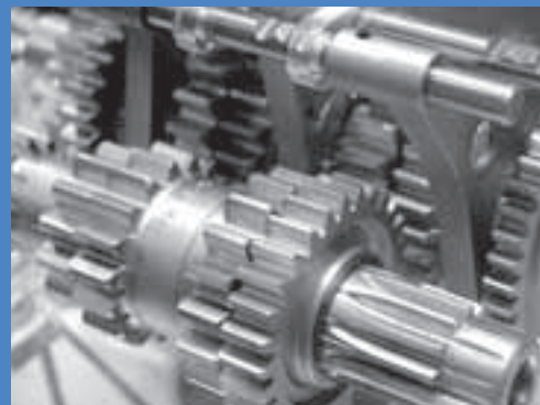
传动系统例如齿轮箱和传动轴在承受扭振的情况下，将会产生振动噪声问题。
