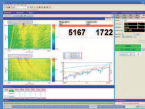
将方便的窄带谱分析、精确地同步采样阶次分析、以及用于后处理的原始时间信号记录结合起来。
