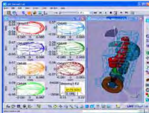
对燃烧载荷，液动轴承和柔性发动机缸体进行建模，以快速获得精确结果。
