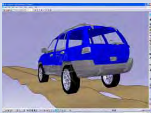
仿真汽车在平路面,或在平坦的2维或3维路面(包括数字试验场)上行驶。
