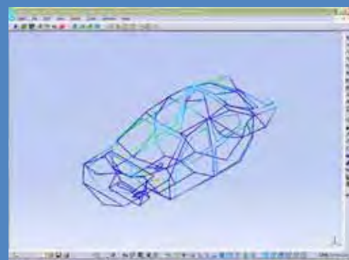
关键频率下的结构变形突出了潜在的声学关键区域。
